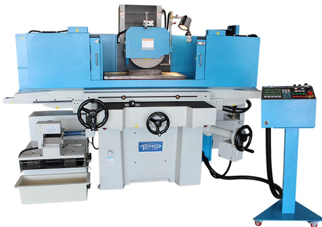
La gamme des rectifieuses planes col de cygne à meule tangentielle couvre une grande partie des besoins en rectification
