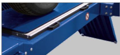
Plaque coulissante de précision (Option, uniquement pour modèle „W“) ; Couple min. initial de détachement 5 Nm et force de déplacement minimale de 15 N pour une charge de roue de 500 kg, grosse quantité de boules d'acier, surface de roulement trempée, rainures collectrices d'eau sale.(Ill. : plaque supérieure démontée)
