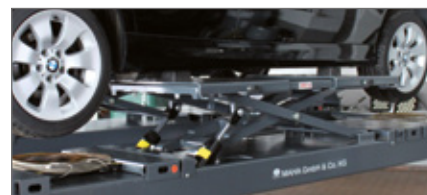
Élévateur roues libres, capacité de levage 3,5 t les rallonges peuvent être tirées même quand la plate-forme est abaissée, réglable en longueur de 1,4 à 2,0 m
