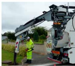
Equipé d'un bras multifonctions, l'Europa a avant tout été pensé pour la sécurité et la productivité durant les opérations de travail depuis l'arrière du véhicule. Avec sa fonction optimum, il économise 25% de gazole et 30% d'eau par rapport à un combiné traditionnel supplantant la plupart des recycleurs.
