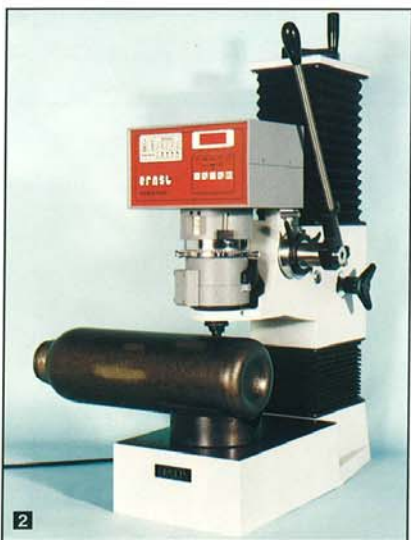
AT 130 DR/T (1) Le contrôle de pièces de grandes dimensions est possible. Dans ce cas le pénétrateur a une prolonge de 50 mm. L'ensemble groupe de vis a été enlevé. Le plan d'appui mesure 240 x 330 mm
