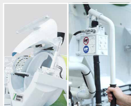
Trémie de remplissage orientable hydrauliquement (facilite le nettoyage à haute pression du tambour de malaxage)
