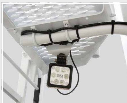
Projecteurs de travail à LED en-dessous de la plate-forme du poste de contrôle
