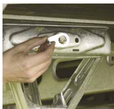
Mettre la sécurité anti-rotation.
