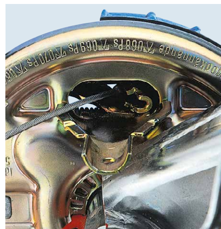
Accrochage du câble dans le frein
