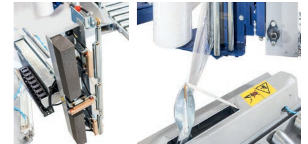
GRUPE PINCE, COUPE ET DISPOSITIF D'ENDUCTION (OU SOUDEUSE EN OPT.) GREIF-, SCHNITT- UND ANLEGERAGGREGAT (SCHWEISSVORRICHTUNG ALS OPTION)
