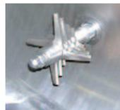
Choppers de dispersion avec paliers équipés de joints d'étanchéité
