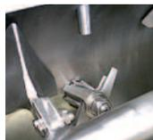
Canne de pulvérisation liquide pour process d'agglomération, de granulation et d'enrobage
