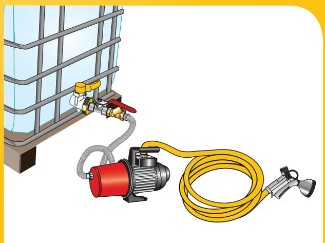
Idéal pour sortie sur une pompe (à compléter par un filtre anti-sable en sortie de vanne)
