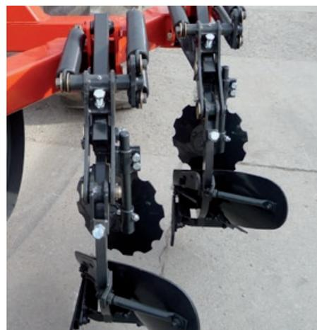
**Coutres déflecteurs pour un enfouissement optimum des pailles. Le premier corps est démontable pour longer les clôtures et peut se remonter éventuellement à l'arrière.**
