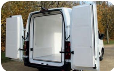
Isolation des ouvrants d'origine par des contre-portes isothermes. Double joint d'étanchéité.
