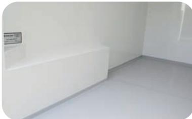
Plancher antidérapant à bords relevés avec caissons passage de roue.
