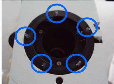
Mettre quelques points de graisse (basse viscosité) (tube fourni dans le colis de la tête) sur le pourtour de l'embase (partie statif).
