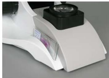
Avant ou pendant vos observations, vous pouvez stocker vos lames dans le range-lames intégré au statif de chaque côté du bloc éclairage qui permet de recevoir jusque 10 lames au total.
