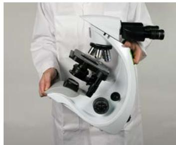
Avant de déplacer votre microscope, s'assurer que les oculaires soient fixés dans leur tube oculaire. Le saisir d'une main par la poignée de préhension à l'arrière du microscope et de l'autre, par l'encoche située à l'avant en dessous du microscope.
