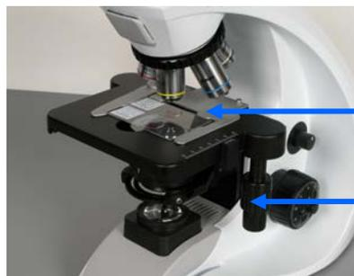
Placer délicatement la lame à observer en la glissant sur la platine, lamelle vers l'objectif. La maintenir avec la pince du guide-objet. Ce guide-objet permet de maintenir deux lames à observer en simultanée.
