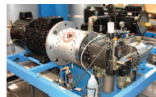
Étanchéité sans entretien de pompes de dosage de polyol et isocyanate pour machines à couler haute pression.
