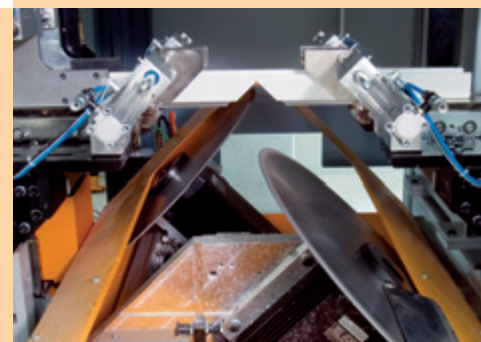
Scie - VU ULTRA SPEED 45°/135° L'avance des lames à commande numérique pour des cycles de coupes à 7 sec/pièce
