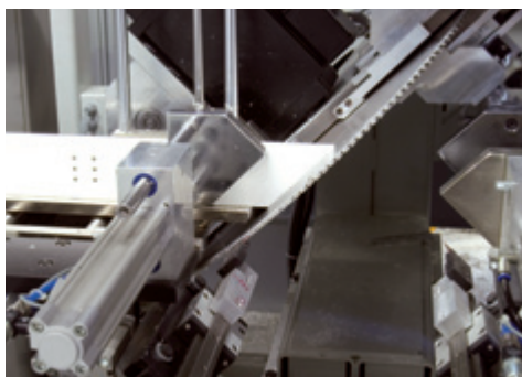
Scie basculant FLEX 45°–135° Réglage angulaire par CN 30°–150° optionnelle
