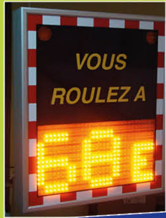
Affichage du coût du PV quand la vitesse relevée est supérieure à la limitation (ici amende de 68€)
