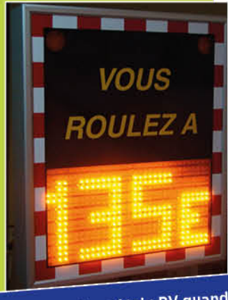
Affichage du coût du PV quand la vitesse relevée est supérieure à la limitation (ici amende de 135€)
