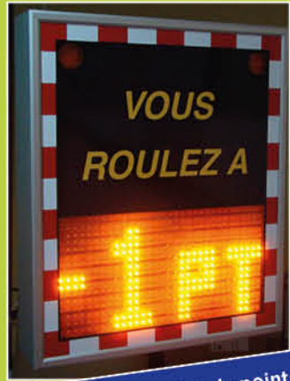
Affichage du nombre de points retirés quand la vitesse relevée est supérieure à la limitation (ici -1 points); en fonction du dépassement de -1 à -6 points
