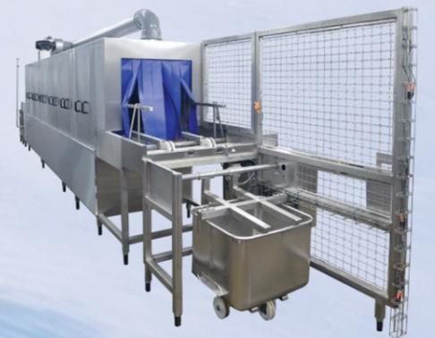
Lavage de chariots sur roulettes ou de grands contenants avec le bras de buses rotatif. La conception du bâti et de la porte de la machine permettent le basculement du contenant pour le vider. Existe en version traversante.
