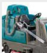
Le **flexible auxiliaire d'aspiration** ramasse rapidement divers débris légers tels que les films plastiques.
