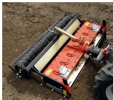
Réglage continu de la profondeur de travail à l'aide d'une tige
