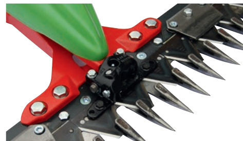
Dispositif de fauchage, fourche d'entraînement et barre de coupe
