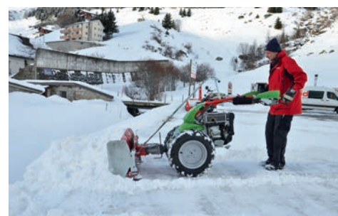
Encore plus de rendement et de confort lors du déblaiement de grandes quantités de neige grâce aux oreilles latérales.
