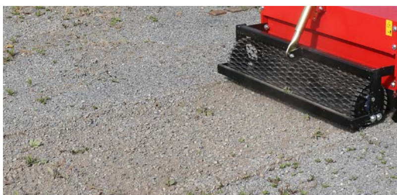
Résultat: Les plantes arrachées reposent sur des couches intactes.
