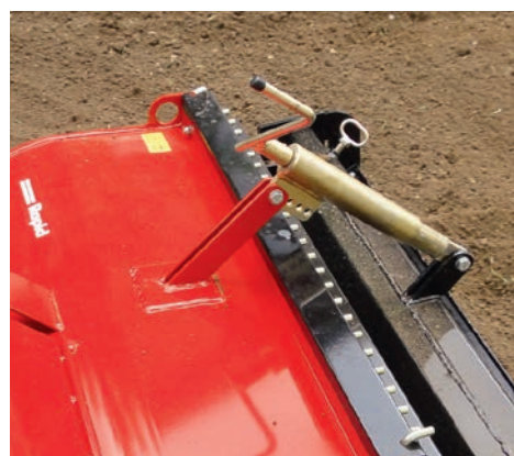
Réglage en continu de la profondeur de travail à l'aide de la tige
