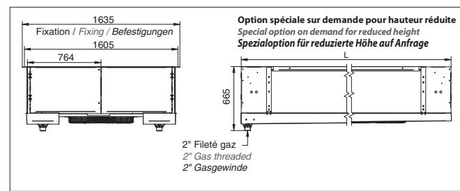
Les dimensions sont données en mm avec une tolérance de ±10mm.
