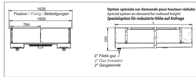
Die Abmessungen sind in mm mit einer Toleranz von ±10 mm angegeben.
