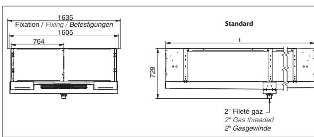
Les dimensions sont données en mm avec une tolérance de ±10mm.
