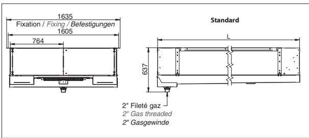
Les dimensions sont données en mm avec une tolérance de ±10mm.
