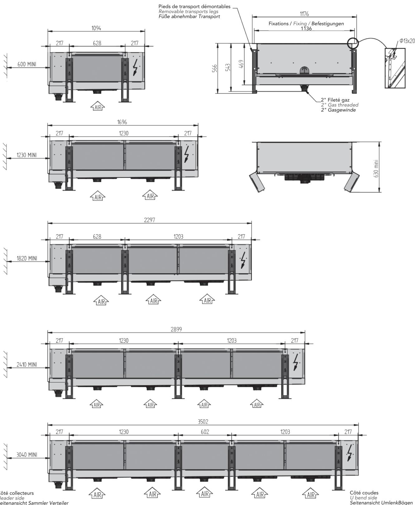
Les dimensions sont données en mm avec une tolérance de ±10mm.
