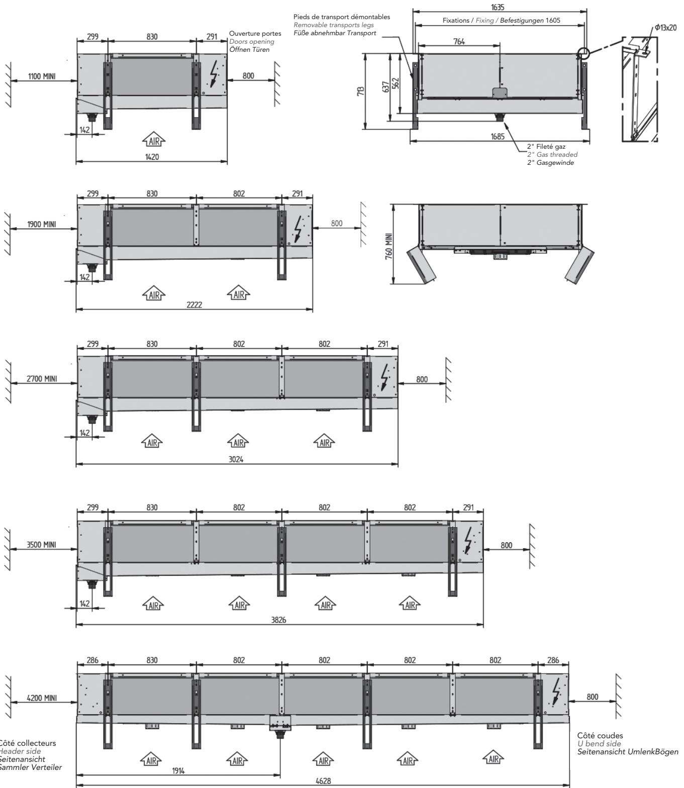
Les dimensions sont données en mm avec une tolérance de  $\pm 10\text{mm}$ .
