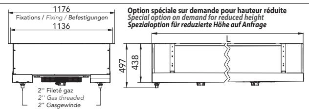
Les dimensions sont données en mm avec une tolérance de ±10mm.
