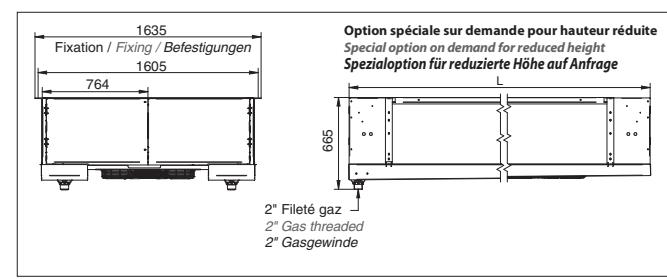
Die Abmessungen sind in mm mit einer Toleranz von ±10 mm angegeben.
