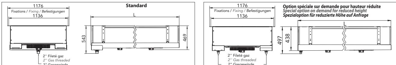
Les dimensions sont données en mm avec une tolérance de ±10mm.
