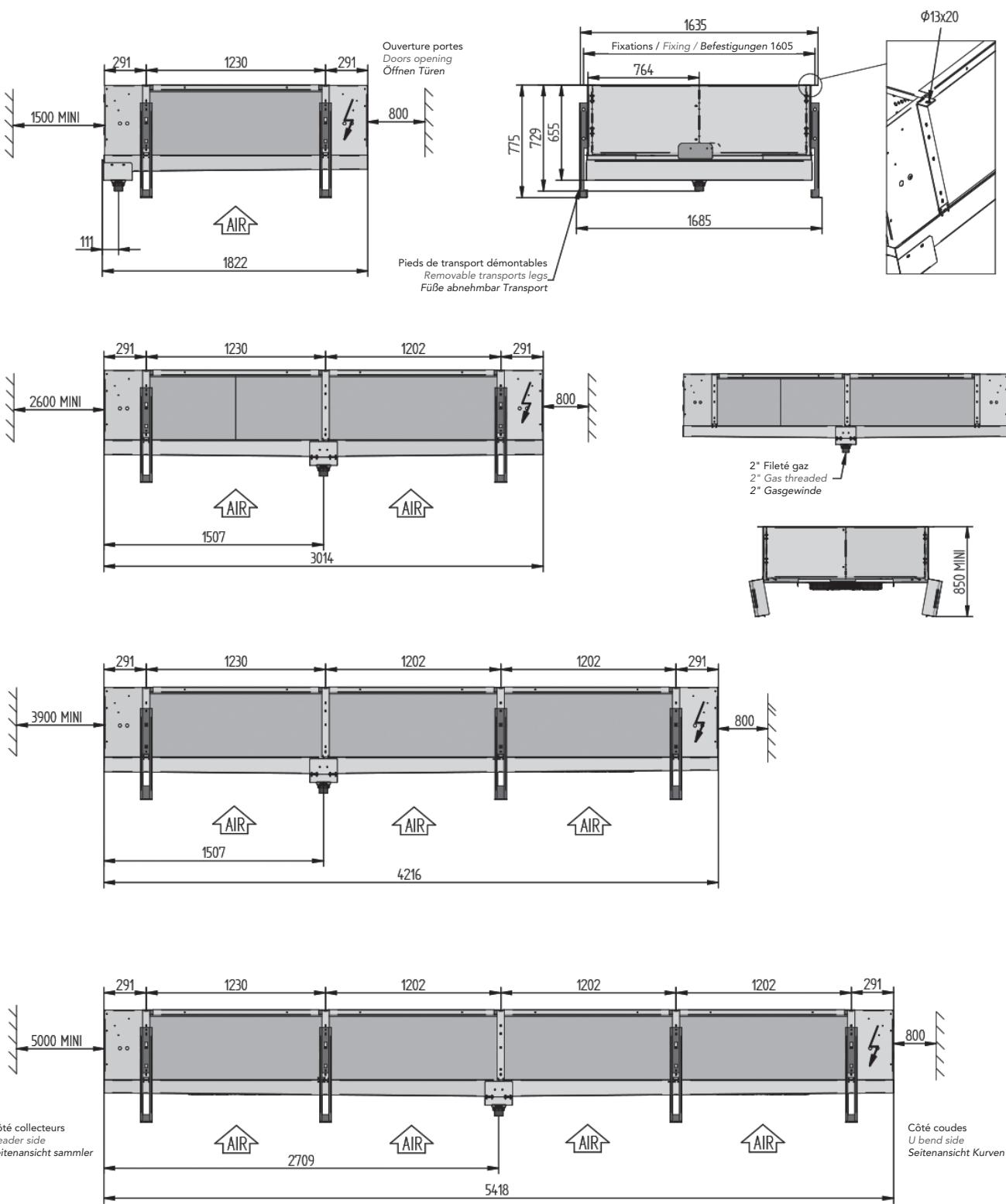
Les dimensions sont données en mm avec une tolérance de  $\pm 10\text{mm}$ .
