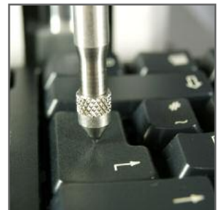
Test de compression sur touches clavier
