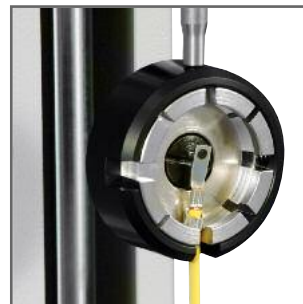
Test de résistance de sertissage
