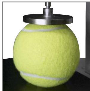
Test de compression sur balle de Tennis
