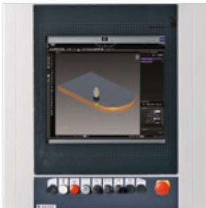
Système de contrôle BH 660 sur base PC avec système d'exploitation Windows en temps réel pour le contrôle de la machine et l'interface utilisateur.
