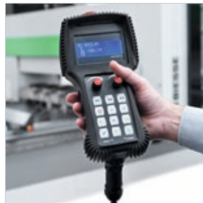
Console à distance pour le contrôle direct et immédiat par l'opérateur.
