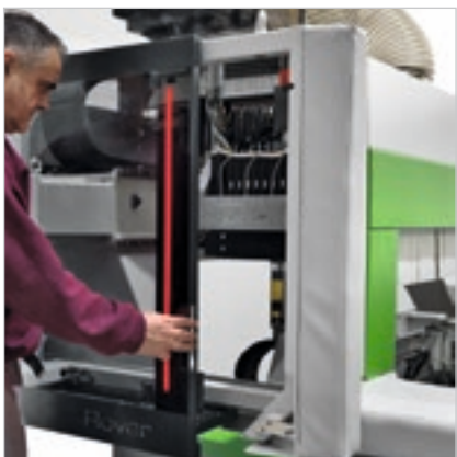
Nouveau carénage avec portillon frontal en Lexan ouvrable, pour travailler en toute commodité.
