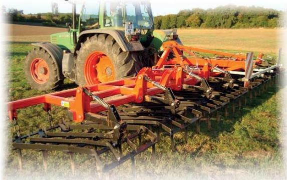
Trois positions de tirage des compartiments par chaînes permettent une meilleure souplesse d'utilisation.
