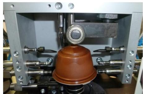
Figure 2 – Capsule disposée sur sa plaque tournante et palpeurs de mesure
