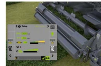
L'alimentation hydraulique peut être paramétrée confortablement depuis le siège du tracteur.
