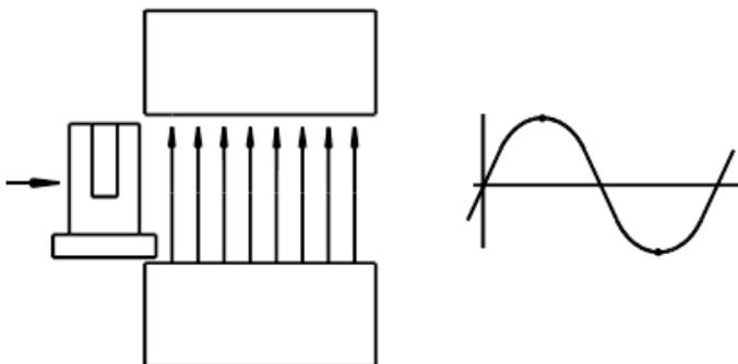
**Principe de fonctionnement par déplacement de la pièce dans le champ magnétique**
