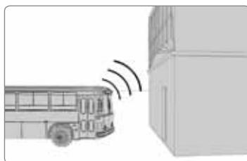
Le nouveau EAD ALCOLOCK™ V3 wifi transmet automatiquement les données chaque fois que le véhicule rentre à son point de stationnement équipé d'une borne de transmission; la transmission est sécurisée au moyen d'un cryptage des données sur le standard AES 128; l'ensemble des données de tous les véhicules peut être visualisé en ligne sur le serveur central de la flotte.
