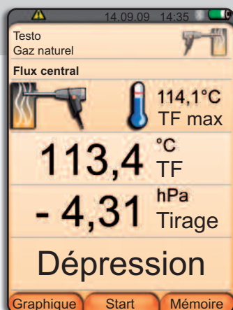
L'interprétation de la mesure: dépression constatée (-4.31 hPa)
