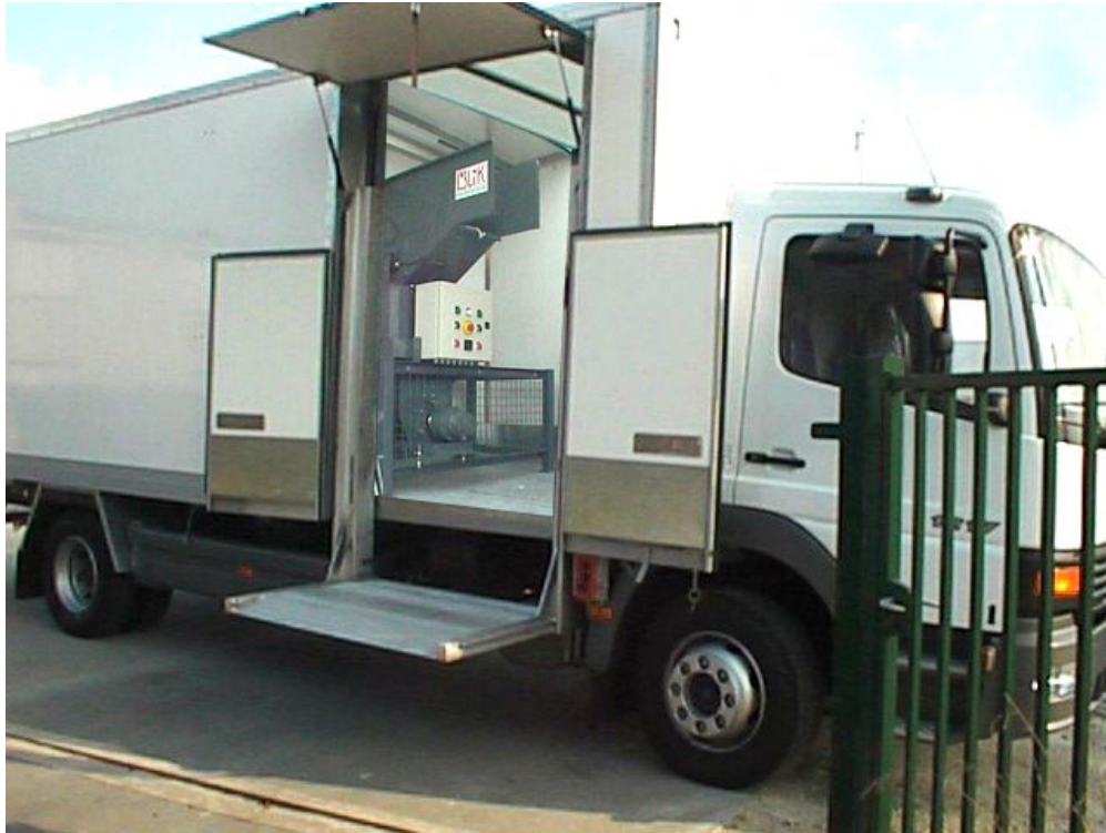
Compartiment de récupération des déchets broyés
