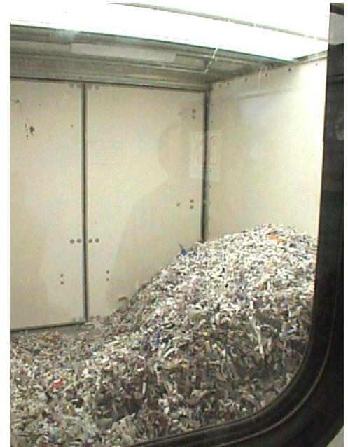
Compartiment de récupération des déchets broyés
