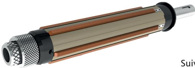
Conçus pour l'enroulage et le déroulage de bobines de faible charge, en porte-à-faux. Ces arbres permettent de régler la position de la bobine par rapport au bâti machine, sans avoir à dégonfler l'arbre.
