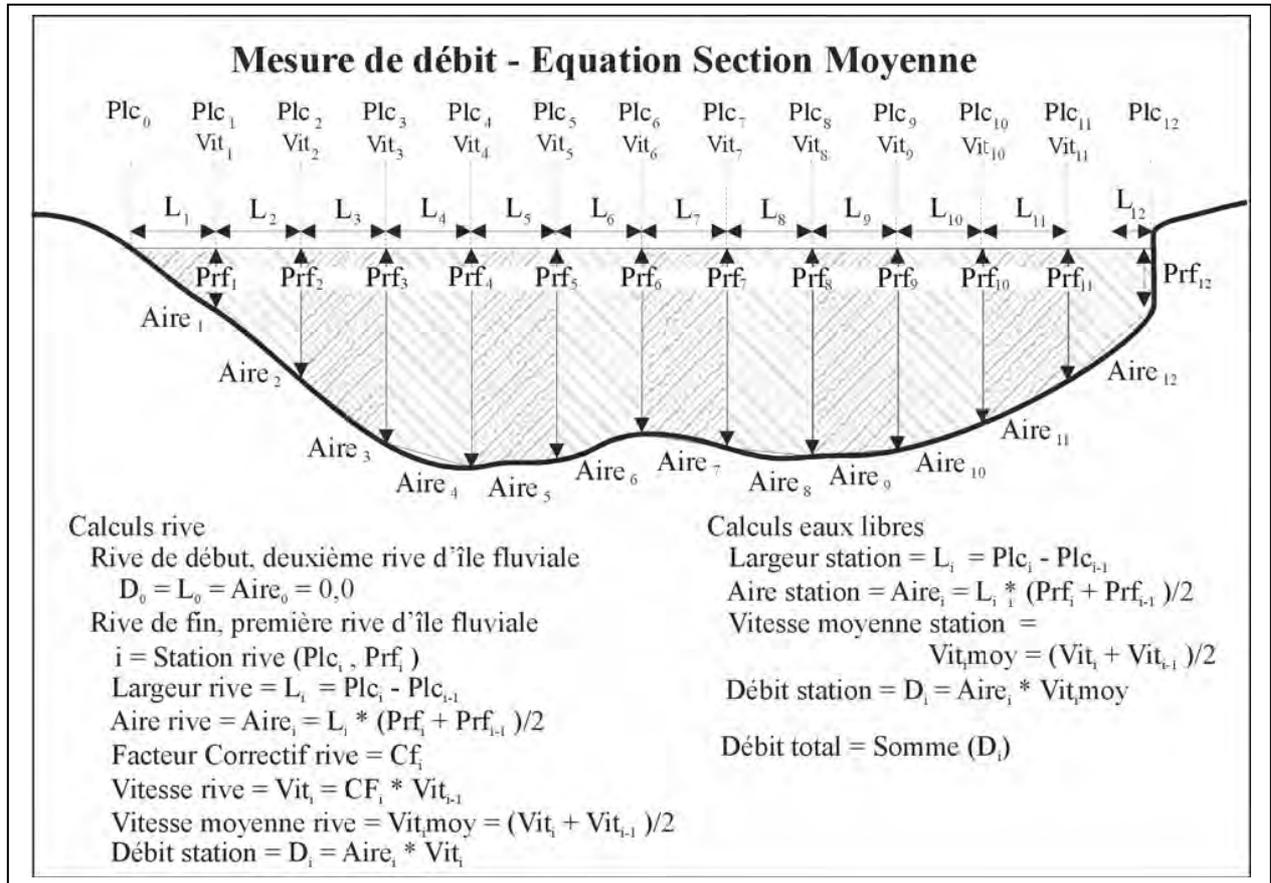
Le calcul de débit utilisant la section individuelle partielle et les mesures de vitesse relevées au travers du canal d'écoulement :
