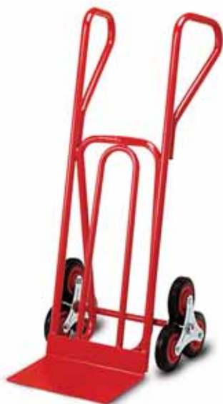
1 DS LD11 E0E Diable escalier avec dispositif en étoile : 2 x 3 roues semi-élastique \varnothing 160mm, permettant de gravir et de descendre les escaliers sans rupture de charge. Facilite le franchissement de marches, quais et obstacles.
