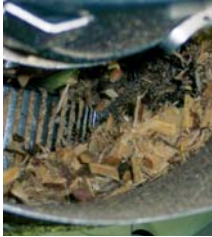
Broyage de bois en plaquettes entre les galets et la filière
