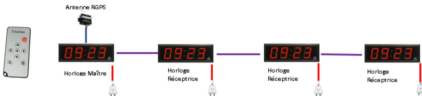
**\*Longueur Câble maximum : 50 mètres entre l'antenne RGPS et la dernière horloge**
