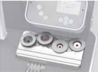
Indexierte Ablage für die Wechselscheiben ISGS3201-0 bis 3 (Ø 3 – 32 mm). Beim Automatik-Schrumpfen wird die passende Wechselscheibe mittels einer LED in der Ablage angezeigt.
