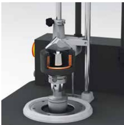
Bild 2 : Positionierung Spule
