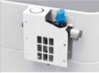
Bestehend aus abschließbarem Absperrventil, Feinfilter mit Wasserabscheider und Druckmanometer. Mit dem Absperrventil kann das Gerät drucklos geschaltet werden. Bei wechselnder oder schlechter Druckluftqualität garantiert der Feinfilter eine zuverlässige Funktionsweise des Schrumpfgerätes.
