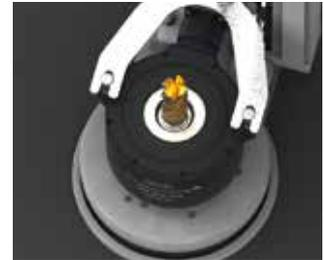
Spulen unterschiedlicher Größe über Schnellwechselsystem adaptierbar
