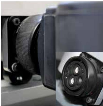
Das Spulensystem kann optional mit einem Schnellwechselmechanismus ausgestattet werden. Dies ermöglicht es, auch Werkzeuge in Sonderabmessungen jederzeit mit entsprechend angepasster Spule ein- und auszuschumpfen. Der Einsatzbereich kann somit permanent auf veränderte Gegebenheiten angepasst werden, ohne ständig in neue Gerätetechnologie investieren zu müssen. Die Option ist nur für die ISG3400 Serie erhältlich.
