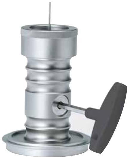
Die Ausstoßeinheit ermöglicht das einfache Entnehmen abgebrochener Werkzeuge aus den Spannfuttern. Auch Werkzeuge, deren Bruchstelle in der Aufnahme liegt, können problemlos entfernt werden. Mittels verschiedener Adapter kann die Grundaufnahme auf alle gängigen Maschinenschnittstellen (HSK, SK, ABS) angepasst werden. Auch bei einem engeren Passungsspiel (Bohrungsdurchmesser/Werkzeugschaft) können die eingeschrumpften Schäfte problemlos entfernt werden. Weitere Schnittstellen auf Anfrage.
