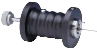
Abgestimmt auf das Luftkühlgerät MS502KS muss die Hantel lediglich um 180° gedreht werden, um den Kühlvorgang starten zu können.
