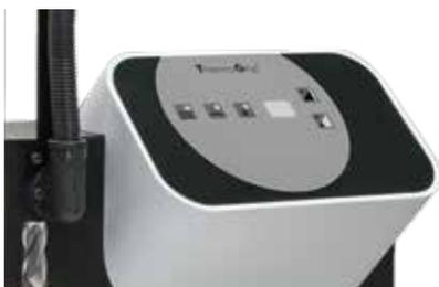
Menügesteuertes, numerisches Bedienfeld mit fest hinterlegten Parametern. Damit besitzen bereits die Einstiegsgeräte eine wichtige Sicherheitsfunktion, welche bei sachgerechter Handhabung das Überhitzen der Schrumpffutter vermeidet.
