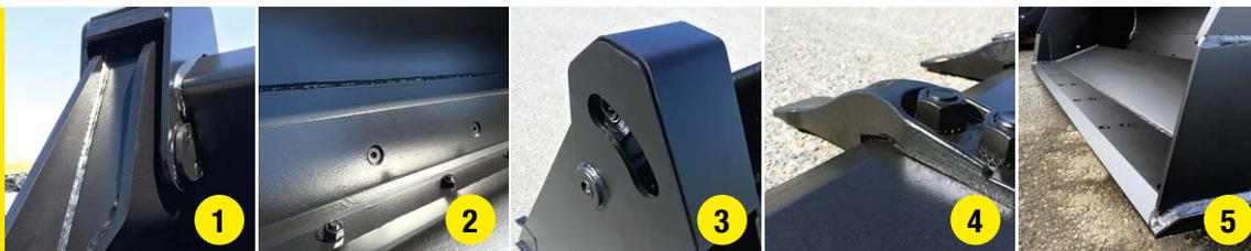
1. Articulation robuste et protégée par des bagues d'usure avec graisseur
