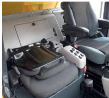
L'instructeur dispose d'un siège à part entière, équipé d'une ceinture de sécurité 2 points à enrouleur automatique.
