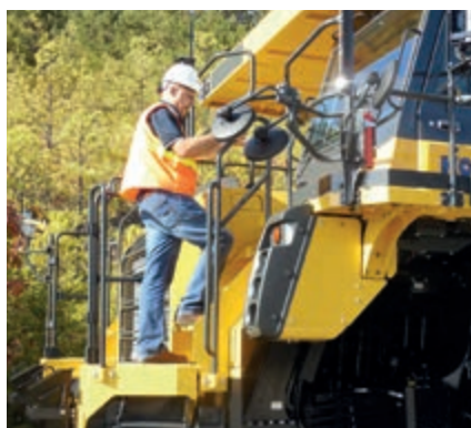
Accès à la cabine en toute sécurité grâce à l'angle faible de l'escalier frontal antidérapant équipé de mains courantes.
