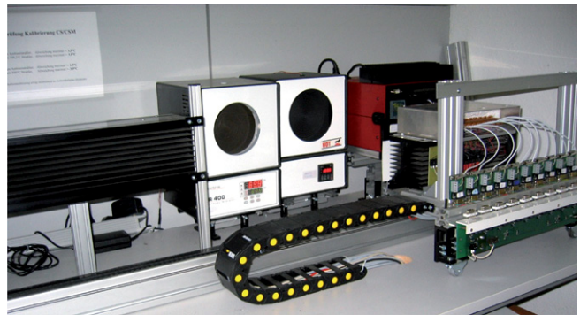
Banc d'étalonnage automatisé chez Optris GmbH
