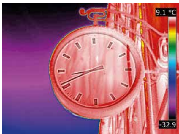
Image thermique avec le mode MSX® : Bien que le verre ne soit pas transparent pour le rayonnement infrarouge, l'image thermique avec le mode MSX® montre clairement les aiguilles de l'horloge derrière la vitre.
