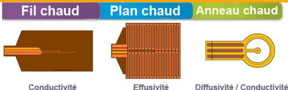
La plupart des méthodes de caractérisation thermophysique que nous développons reposent sur l'utilisation de **sondes à chocs**. Elles permettent de créer une excitation thermique du matériau, la réponse à cette excitation dépend des propriétés thermiques que nous recherchons.
