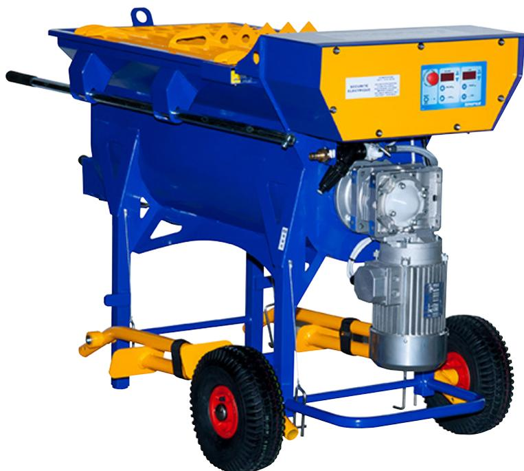
Le malaxeur MIXPRO 100 est équipé d'une double hélice hélicoïdale sur arbre horizontal assurant un malaxage rapide & homogène pour tout type de produits en poudre.
