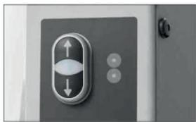
Montée et descente pneumatique du rouleau supérieur par boutons électriques
