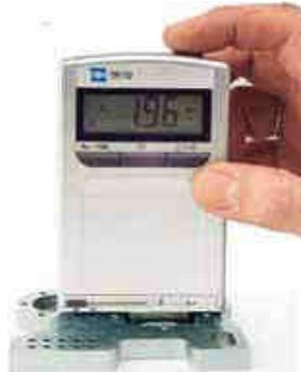
**TYPE :** Appareil "de poche" à affichage digital pour la mesure de rugosité (Ra et Rz) sur pièces plates ou de diamètre supérieur à 40 mm.
