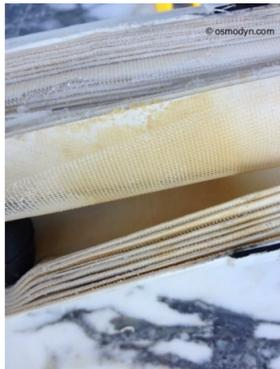
Le fonctionnement d'un procédé de filtration membranaire est conditionné par le colmatage qui est le phénomène qui s'oppose à la filtration. En effet, au cours de l'utilisation, la matière retenue par la membrane s'accumule réduisant ainsi le flux de perméation et donc la productivité du procédé le colmatage reste difficile à éviter ou limiter. Il ne peut être décrit que par autopsie de membrane.
