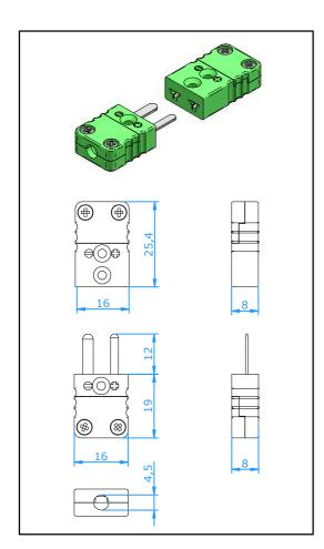
**Application:** Connecteur pour thermocouple et circuit RTD. Convient pour fils minces et câbles à isolation.
