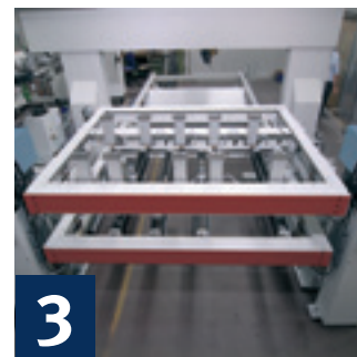
3 Table de machine Deux tables palettes avec un dispositif de serrage par vide
