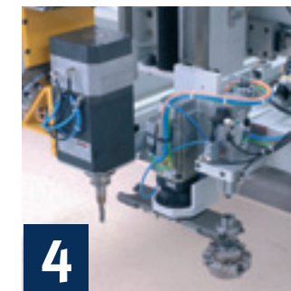
4 Système „satellite“ Changement d'outil par satellite avec vitesse de travail de 150 m/min
