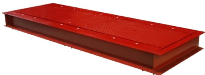
Plateforme renforcée qui permet de calculer le poids d'un véhicule pendant son passage, en additionnant les différents essieux, pesées d'une manière dynamique. Conçue pour une installation au niveau du sol.
