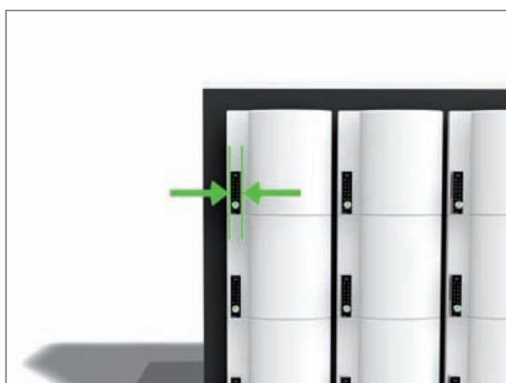
Exemple : Portes de casier bombées vers l'avant
