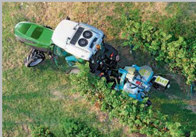
Rayon de braquage optimisé grâce à un support avant plus élargi.
