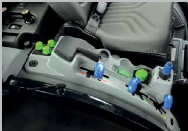
Commandes du relevage hydraulique arrière et des systèmes hydrauliques.
