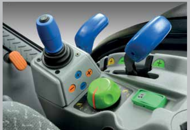
Commandes pour le relevage hydraulique arrière et l'outil de travail hydraulique : proches l'une de l'autre pour en simplifier l'accès.
