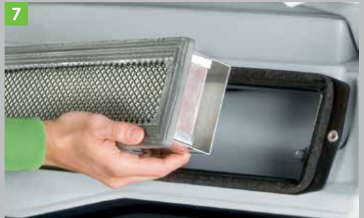
7 Le filtre à air dans la cabine empêche la pénétration de poussière et autres produits chimiques à l'intérieur du tracteur. Un air pur dans la cabine, tout le temps.
