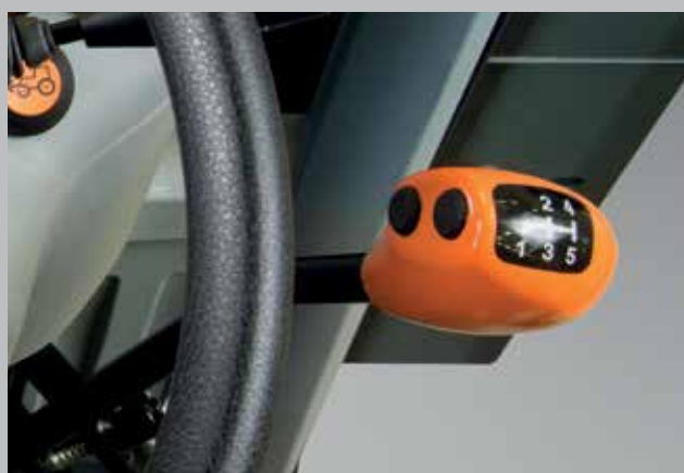
PowerShift. Changez simplement de rapport par pression sur un bouton sans enfoncer la pédale d'embrayage.
