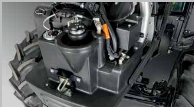
Le réservoir de carburant intégré au groupe du pont avant peut être ravitaillé avec le capot fermé, tandis qu'un réservoir secondaire est situé sous le châssis.
