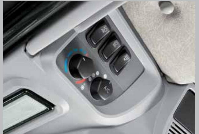
Les commandes de la climatisation et des feux de travail sont faciles à atteindre sur le plafond.
