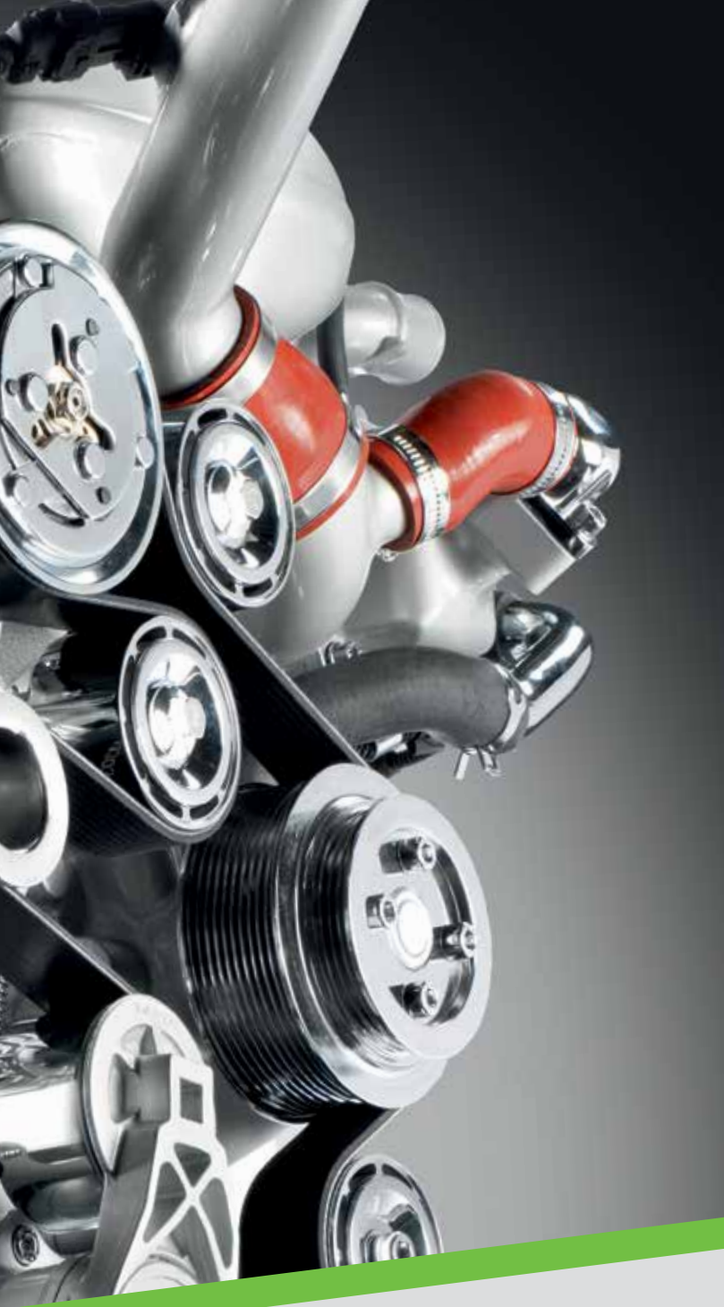
Le moteur est plus efficace grâce à un groupe de refroidissement inédit et plus grand, assorti d'un meilleur débit de l'air et d'un filtre à air Powercore.
