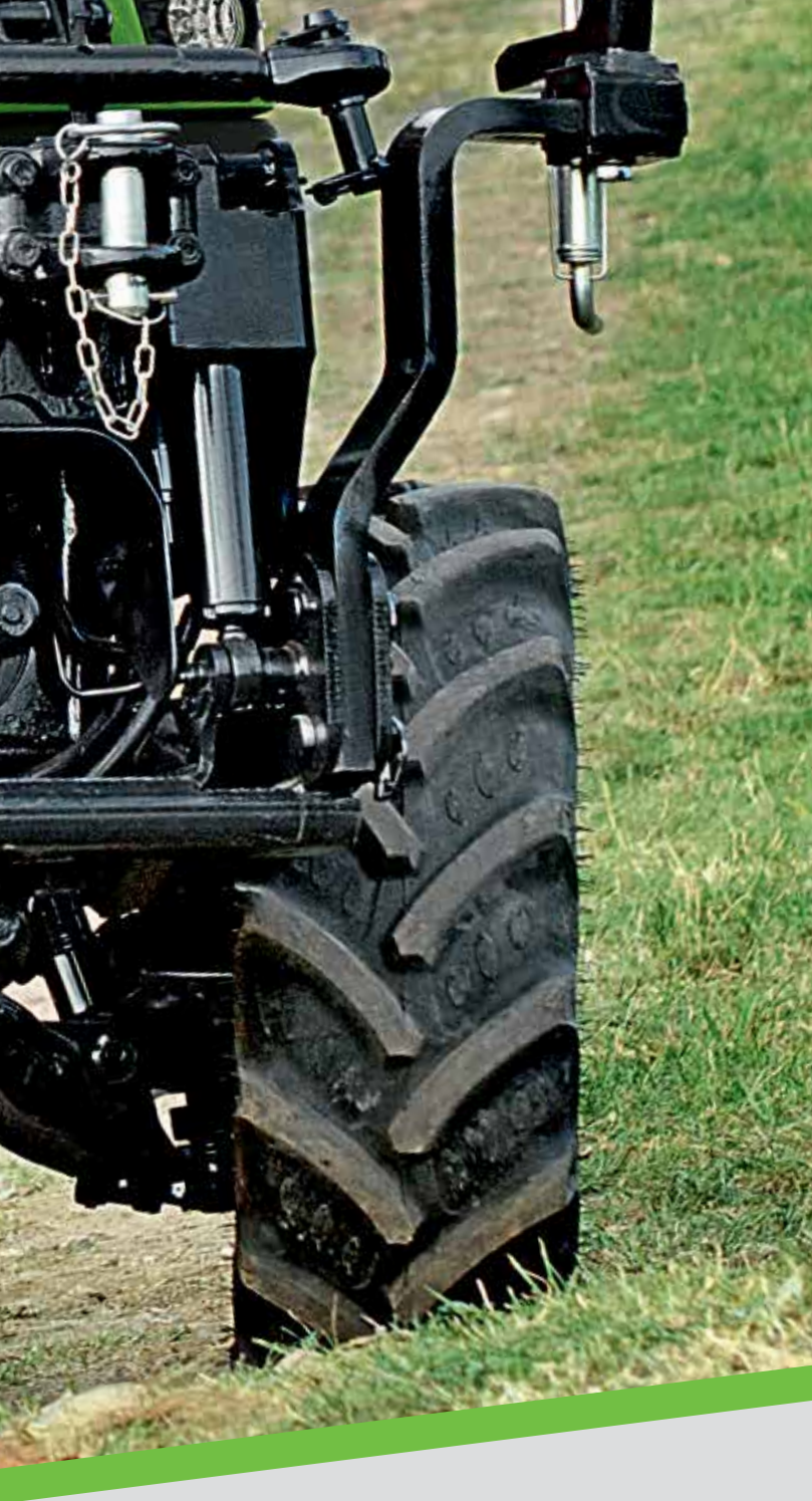
Rayon de braquage optimisé grâce à un support avant plus élargi.
