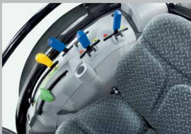
Leviers de relevage arrière mécanique, fonctionnels et ergonomiques.
