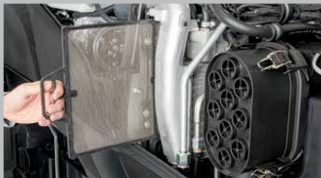
Le moteur est plus efficace grâce à un groupe de refroidissement inédit et plus grand, assorti d'un meilleur débit de l'air et d'un filtre à air Powercore.
