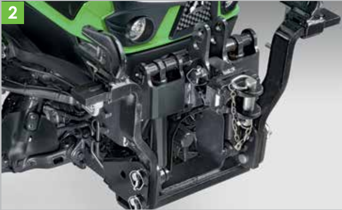
2 Systèmes hydrauliques à l'avant et PDF à l'avant pour des combinaisons d'équipements efficaces.
