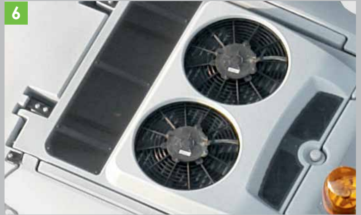
6 Système de climatisation ultra performant pour un environnement travail agréable dans la cabine.
