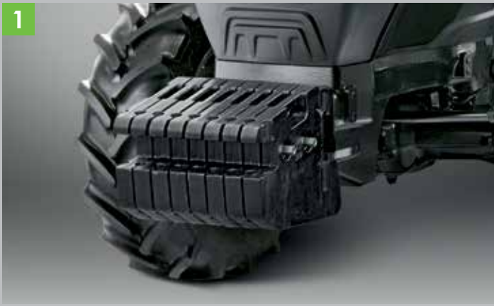
1 Différents poids avant pour le travail avec des attelages arrière lourds.
