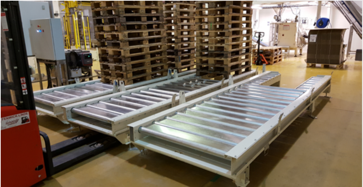
Exemple de ligne d'accumulation de piles de palettes
