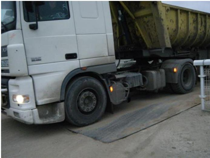
Charge admissible : jusqu'à 100 tonnes / m<sup>2</sup> selon les caractéristiques et la nature du sol
